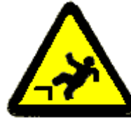
Caduta con dislivello
